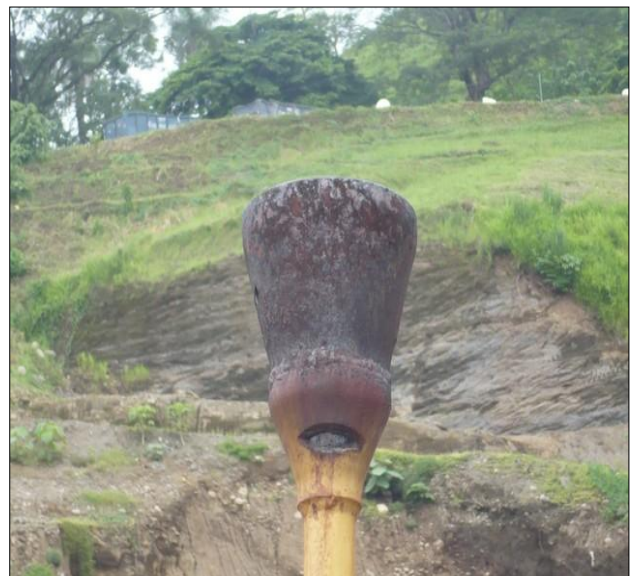
Fig 4. Chimenea utilizada para biogás
