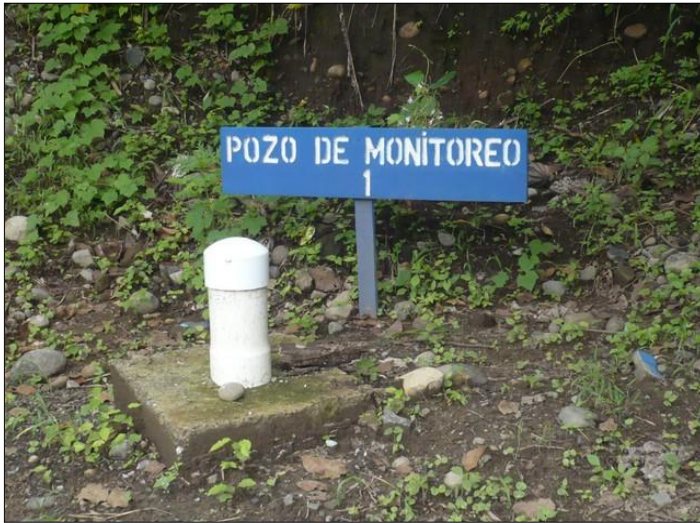
Fig 5. Pozo de monitoreo agua subterránea
